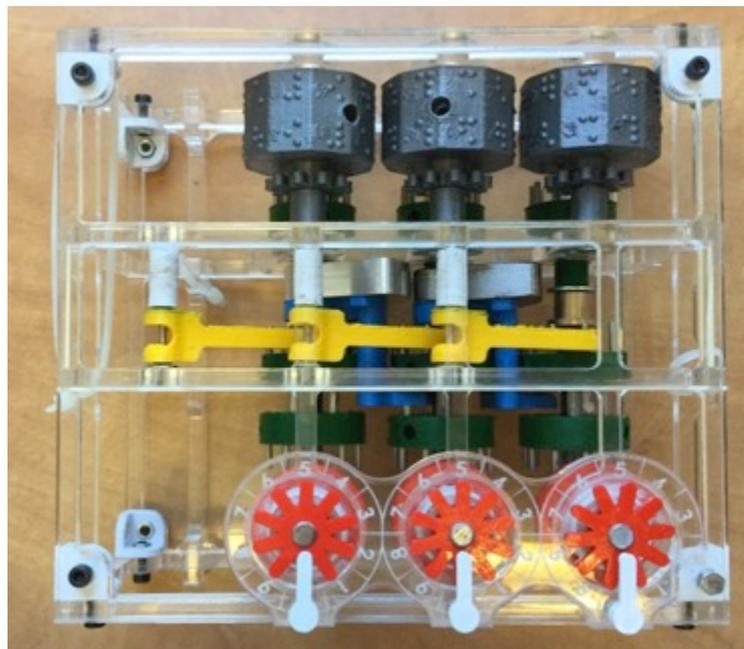
Figure 51. Maquette de la Pascaline réalisée en imprimante 3D, manipulable par les élèves.
