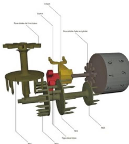
Figure 52. Simulation virtuelle du bloc comprenant la roue de l'inscripteur et celle du totaliseur.
