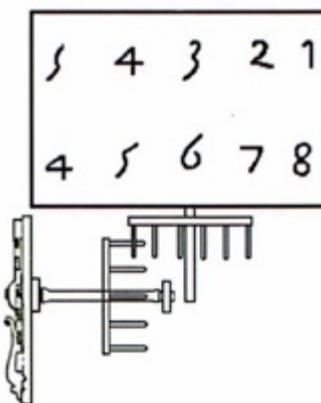
Figure 54. Maquette d'une partie de la pascaline réalisée avec les éléments de la mallette pédagogique. L'engrenage n'est pas plan mais dans deux plans orthogonaux, contrairement à la pascaline utilisée en classe.
