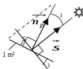
L'éclairement direct sur le plan récepteur (en  $\text{W}/\text{m}^2$ ) est donc  $E_n \times \cos i$ .
