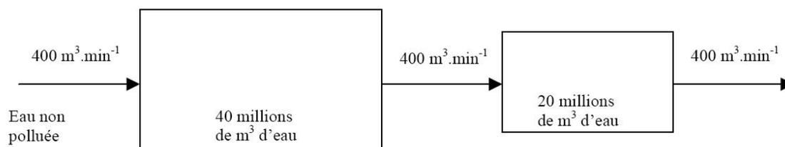
On imagine que la retenue située en amont reçoit une pollution accidentelle de 800 kg de pesticides et on souhaite connaître l'évolution de la masse de pesticides dans chacune des retenues au cours du temps. La retenue située à l'amont est alimentée par de l'eau qui ne contient pas de pesticides. Initialement, la retenue située à l'aval ne contient pas de pesticides. On se propose, sous certaines conditions (hypothèses de modélisation), d'apporter une réponse aux questions suivantes :
