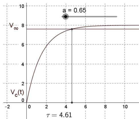
Si on augmente  $a$ , la vitesse du chariot se stabilise plus rapidement autour de sa vitesse limite et la constante de temps diminue.
