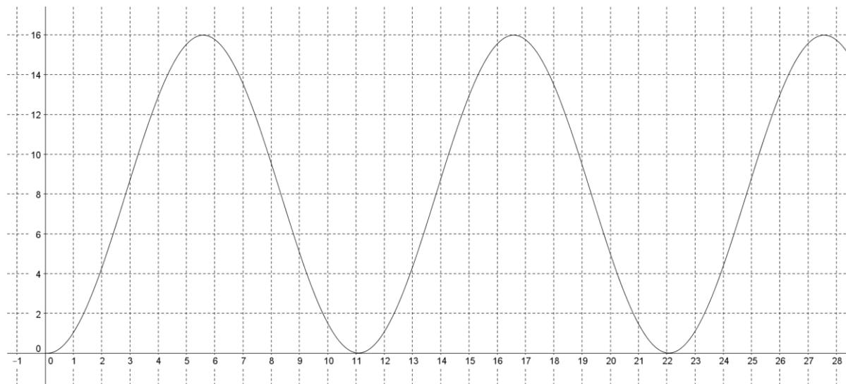
On constate que la vitesse  $V$  de la charge est une fonction sinusoïdale. La vitesse moyenne est de 8 m/s. La charge subit un mouvement oscillant. Il y a donc ballant.
